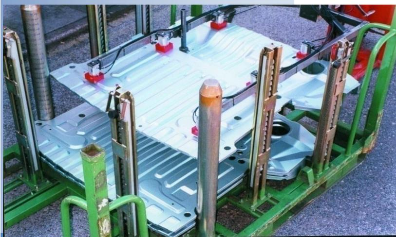
Se vengono paragonate ai sistemi elettromagnetici, meccanici, o alle tecnologie del vuoto, le unità **PSPM** dimostrano una insuperabile capacità di concentrare una grande forza di sollevamento entro aree contenute, su bassissimi spessori di materiale, anche in presenza di superfici di contatto irregolari, perforate, rivestite da
