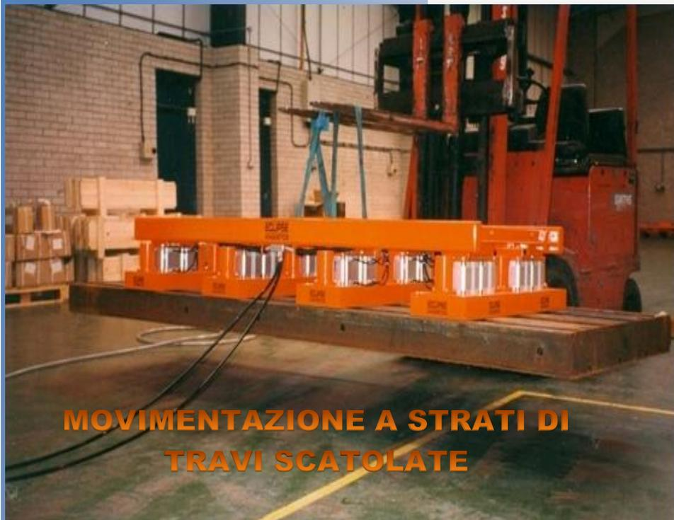
Con un rapporto "peso magnete/forza sviluppata" molto vantaggioso, le unità **Eclipse PSPM** consentono spesso di movimentare carichi ingombranti, che risultano scarsamente gestibili da altre tipologie di magneti. Una soluzione che, con costi di gestione ridottissimi, abbina la indiscussa **praticità** del sollevamento magnetico, con la **sicurezza totale** del magnete permanente, la cui tenuta è sempre garantita, anche in assenza di pressione nel modulo sollevatore.
