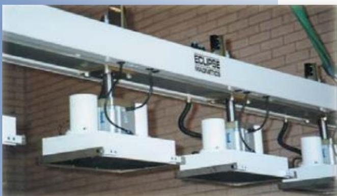
Linea automatica di panificazione. I magneti **Eclipse PSPM** qui illustrati, sono destinati al prelievo da magazzino, ed alla messa in linea, di cestelli per impasto, aventi svariate dimensioni e forme. A fine ciclo, i magneti svolgono l'operazione inversa, depositando a magazzino i contenitori già svuotati, e procedendo quindi per un nuovo carico. Lunghezza linea: 8 mt.
