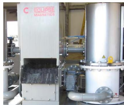
"Il sistema autonomo Double AM12 ha aumentato la nostra efficienza. Lavoriamo 24/7 e le nostre teste da 18" tagliano grossi pezzi di metallo. **La filtrazione magnetica ha ripulito drasticamente i nostri fluidi e migliorato la finitura di superficie che possiamo offrire. Estrae circa 50 kg di scarto ferroso al giorno** e gestisce facilmente il flusso e la contaminazione generata dalle celle multi-macchina."
