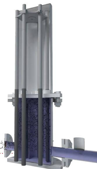
Pulizia automatica : il sistema pneumatico esclude i magneti, la valvola deviatrice si attiva e consente alla contaminazione di essere spinta dal flusso verso il serbatoio, per iniziare la fase di separazione e recupero del fluido.
