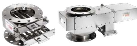
Rimozione corpi estranei - Sistemi di separazione e rilevamento
