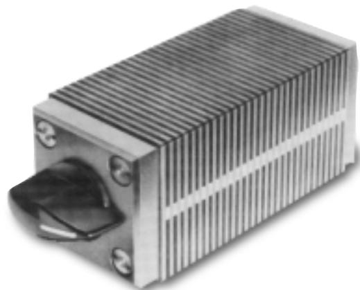
Il blocco magnetico con cave **ECLIPSE** si rivela utilissimo e della massima funzionalità in tutte le operazioni di rettifica su componenti tondi o di forma irregolare. Il suo impiego comporta una notevole diminuzione dei tempi di approntamento e, benché essenzialmente realizzato per l'ancoraggio di sezioni tonde, esso risulta efficace anche nel fissaggio di pezzi rettangolari o poligonali.
